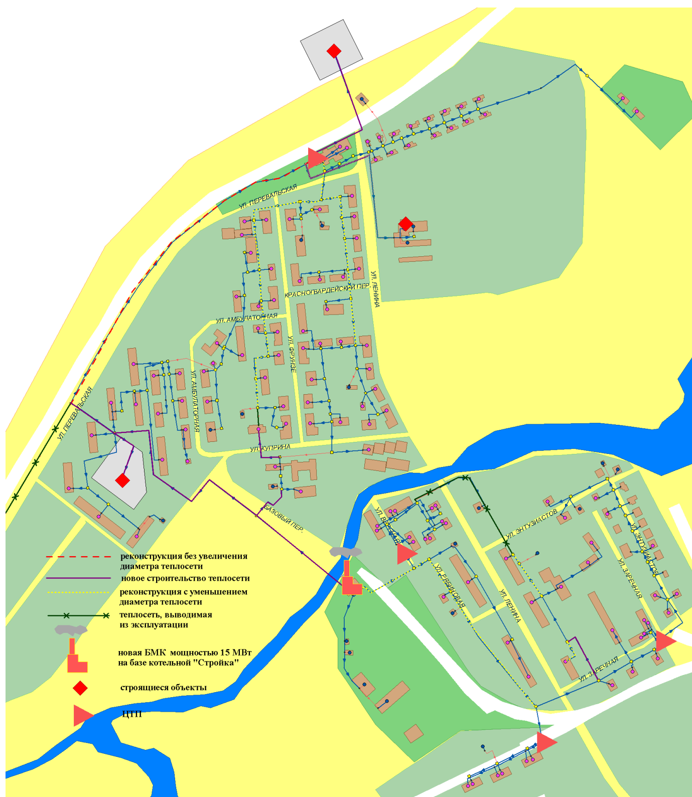
Рисунок 7.7 Предварительная схема трассировки тепловой сети от БМК «Стройка»
