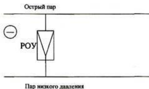
Рис.1. Существующая схема паропровода
