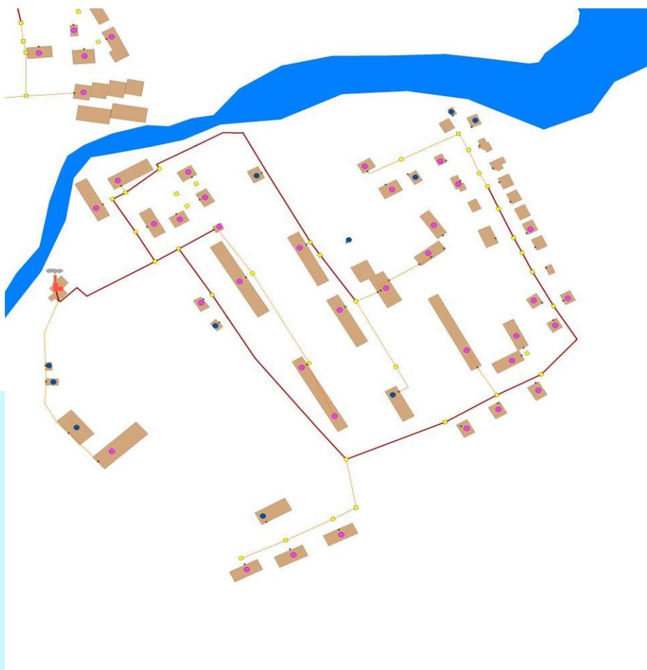
Рисунок 3.20 Схема магистральных трубопроводов системы теплоснабжения от котельной «Стройка»
