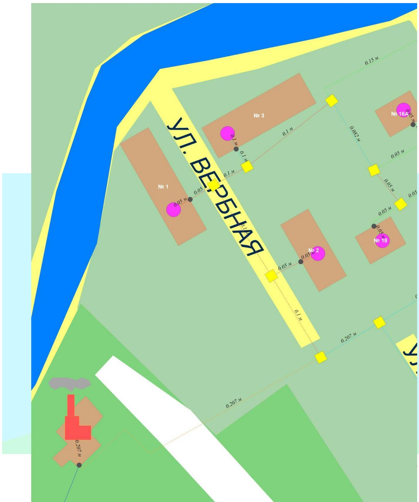
Рис.3.22 – Удельные потери по участкам теплосети от котельной Стройка
