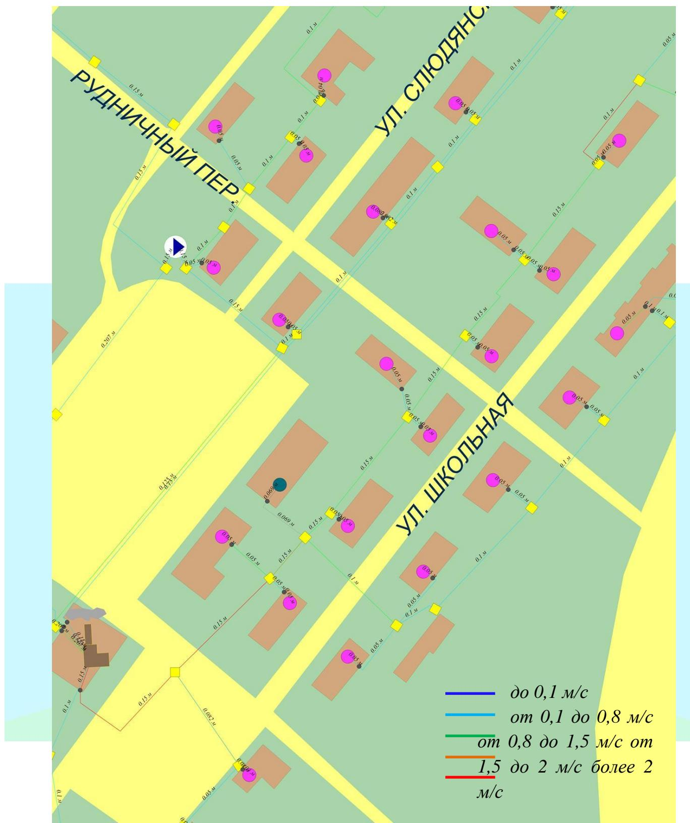
Рис.3.11 - Скорости теплоносителя по участкам теплосети от котельной Рудо
