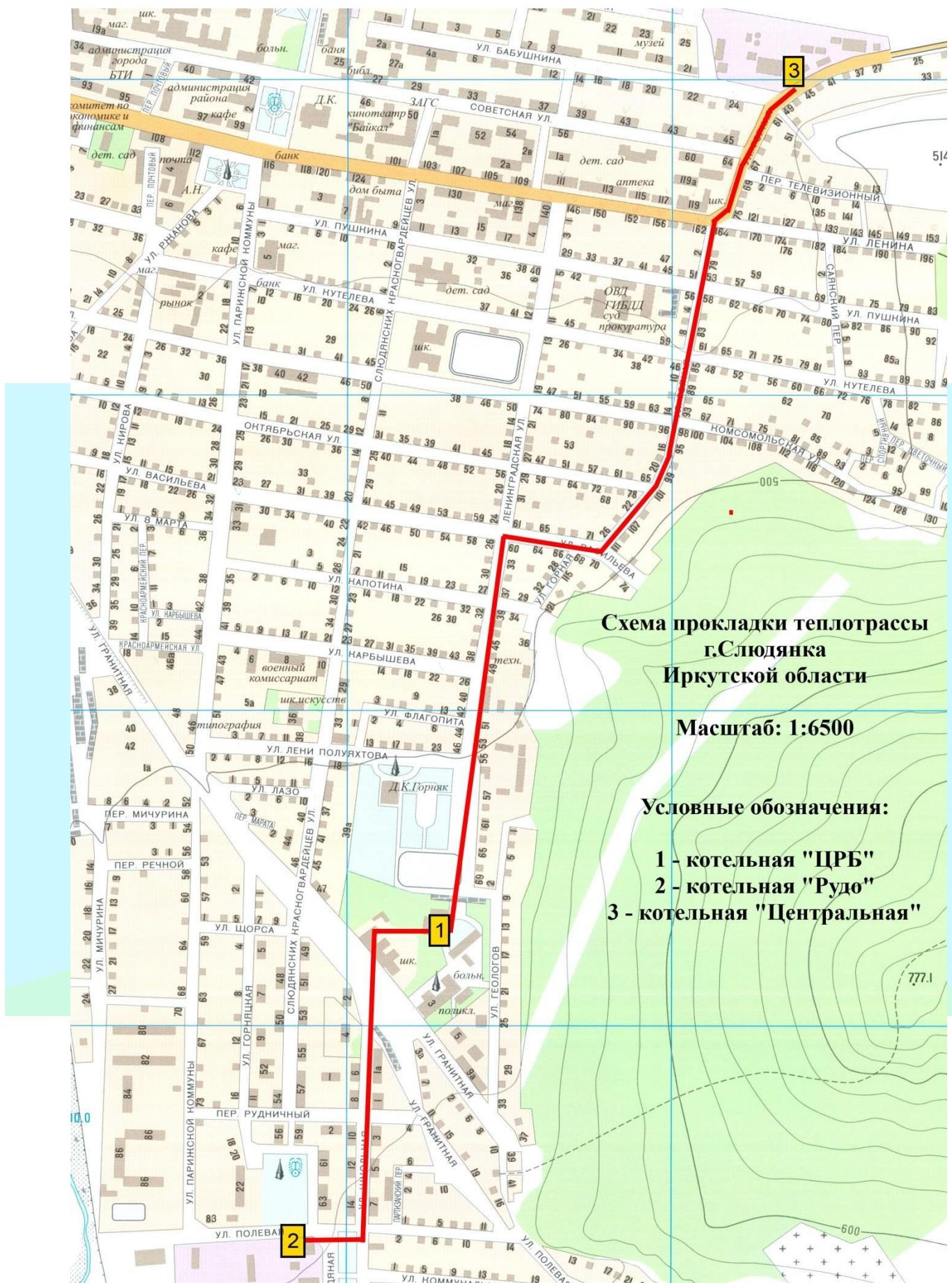
**Рисунок 7.1. Трассировка тепловой сети от «Центральной» котельной к котельной «Рудо»**
