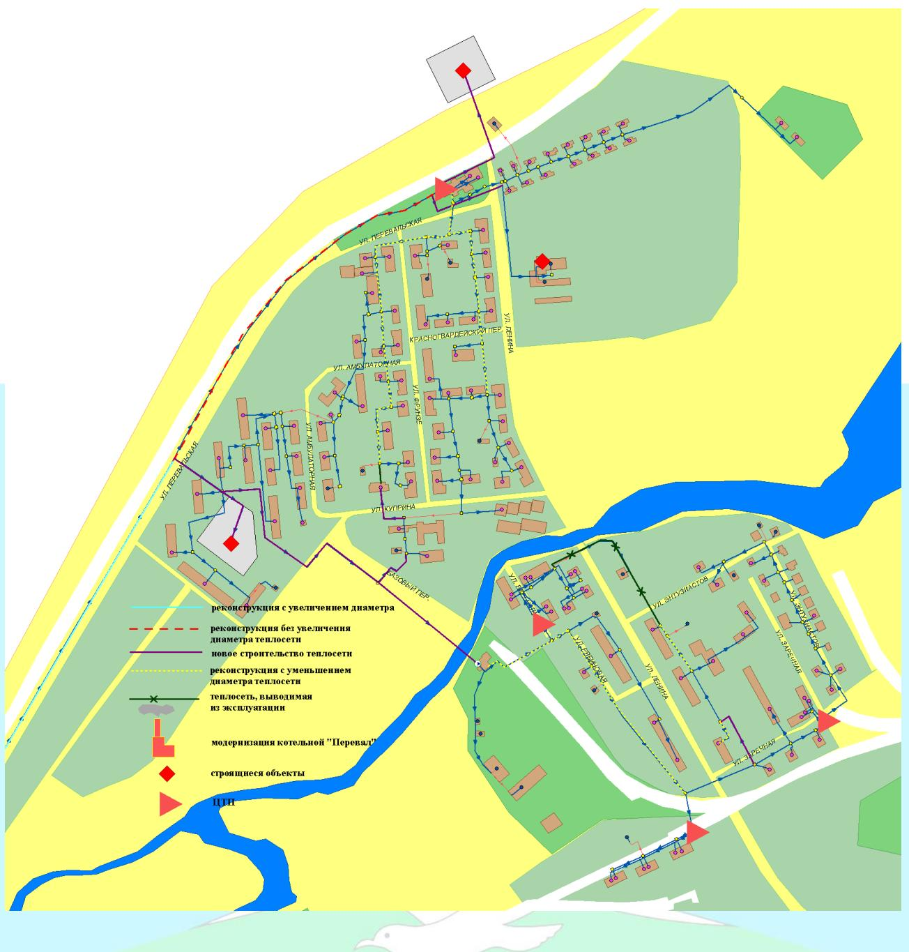
Рисунок 7.8 Трассировка тепловой сети от котельной «Перевал» к котельной «Стройка»
