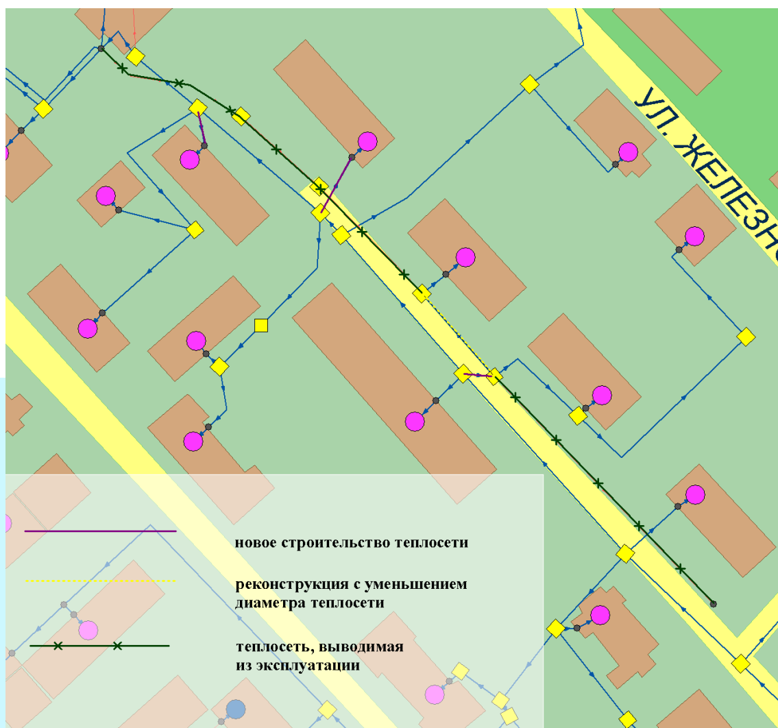
Рисунок 7.4 Переключение потребителей «Центральной» котельной
